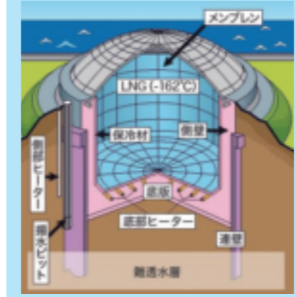
LNG地下タンク LNGを貯蔵します。耐震性にすぐれた地下タンクであるため、万一、亀裂などが生じてもLNGが漏れない構造になっています。
